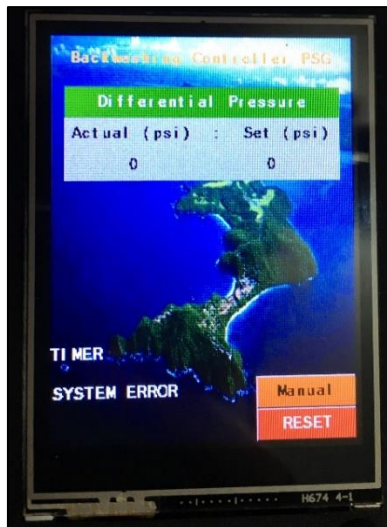
Figura 5.16. Mensaje de disparo de lavado por Timer (controlador en modo backup). Imagen tomada durante una prueba de campo.
