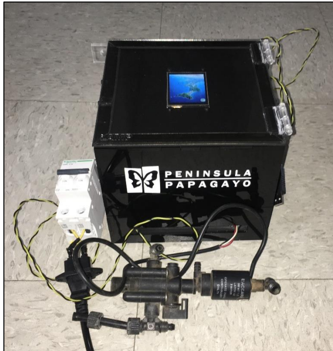
Figura 4.25. Estructura completa de la carcasa del controlador de retrolavados (tapa de protección de la pantalla cerrada).
