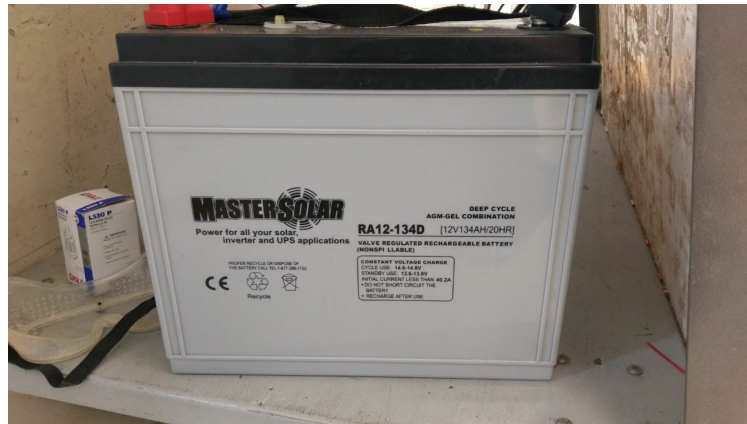
Figura 7.2: Batería empleada para la alimentación principal del laboratorio.
