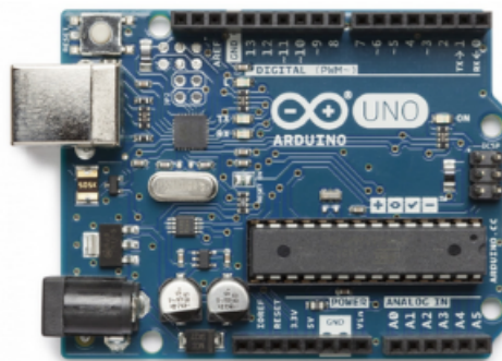
Figura 2.3: Arduino Uno Rev3. Tomado de [3].
