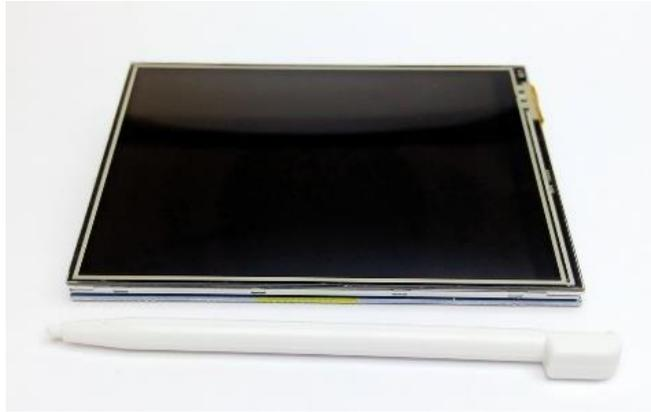
Figura 17. Pantalla táctil LCD TFT 3,5 [26]
