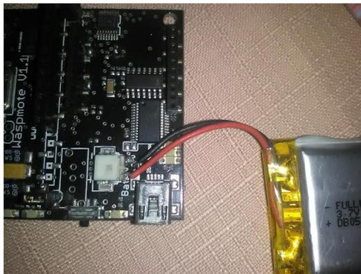
Figura 44. Conexión de batería en el Wasp mote.
