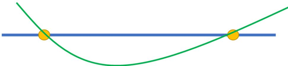
Figura 3. Modo de vibración en una viga con 2 nodos [7].
