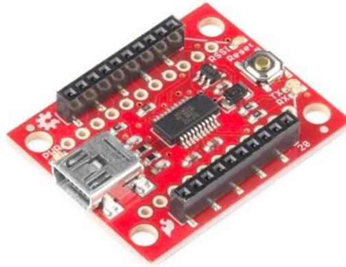
Figura 15. Módulo de Xbee USB Explorer [23]
