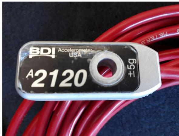
Figura 39. Acelerómetro BDI A2120
