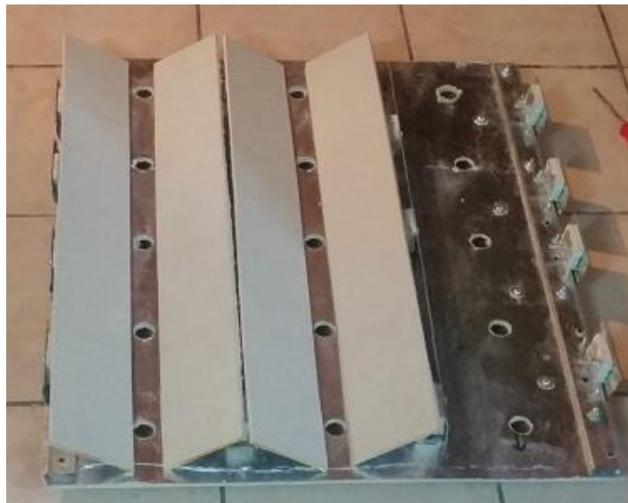
Figura 3.12 Reflector en construcción, se usa lámina de plyrock como base de los angulares.
