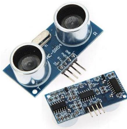
Figura 3-4. Sensores Ultrasónicos HCSR04. [25]
