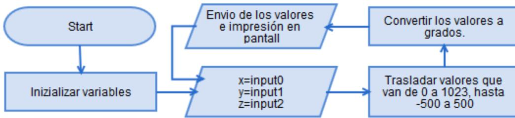
Figura 4-8. Diagrama de flujo del acelerómetro. Diseño propio.
