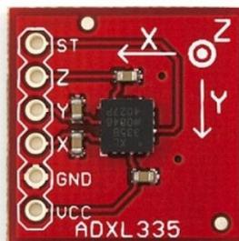
Figura 3-8. Acelerómetro ADXL335. [31]
