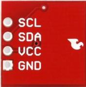
Figura 3-7. Brújula Digital HMC6352, vista trasera. [35]
