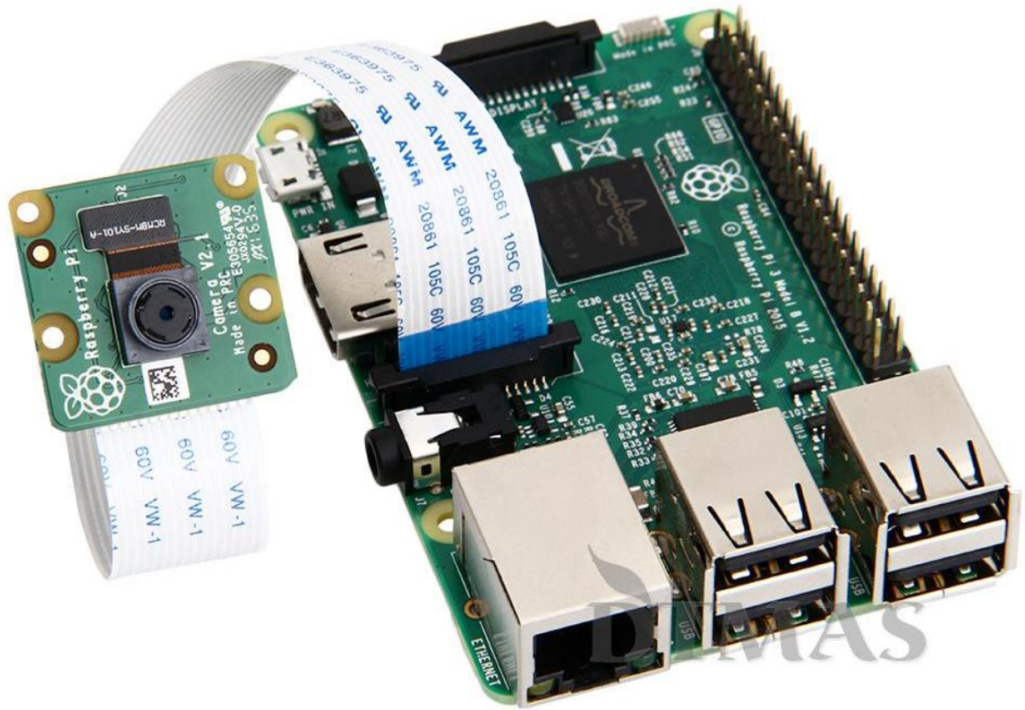
Figura 4-16 Conexión de la Pi Cámara en la Raspberry Pi 3.
