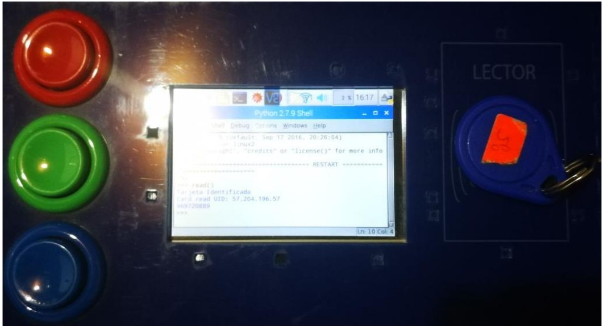
Figura 6-7 Prueba de funcionamiento de la pantalla y el lector.
