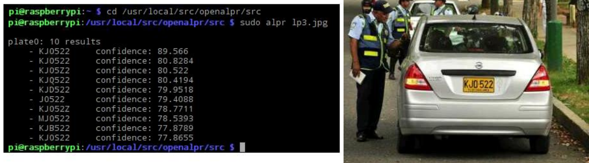
Figura 6-11 A la izquierda se aprecia el resultado de la lectura del programa OpenALPR, mientras a la derecha se muestra la imagen que se analizó.
