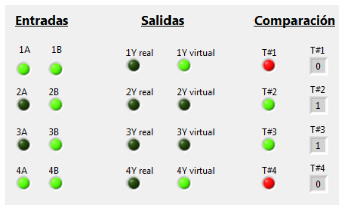
Figura 4.7. Front Panel de la prueba AND TRUTHTABLE TEST para un resultado incorrecto
