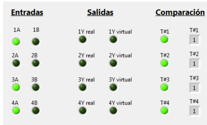
Figura 4.6. Front Panel de la prueba AND TRUTHTABLE TEST para un resultado correcto
