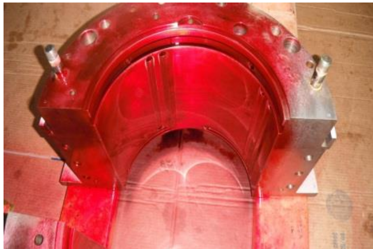
Figura 18. Prueba de tintas penetrantes
