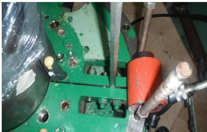
Figura 9. Separación de tapa bipartida
