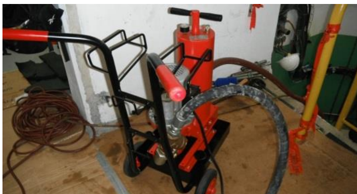
Figura 12. Bomba de filtrado
