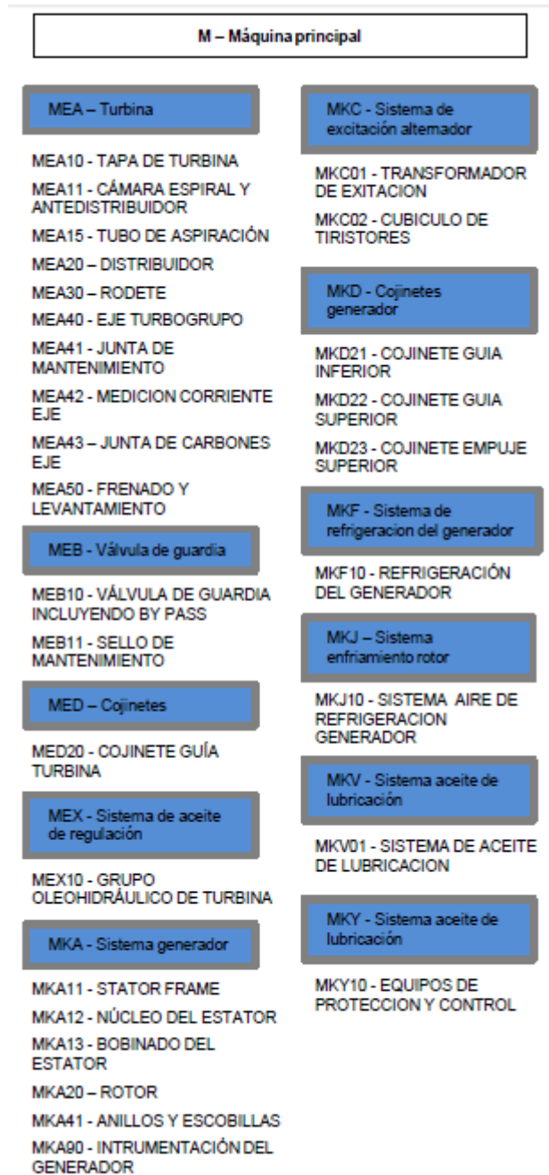
Figura 3.9. Codificación KKS de Máquina principal Fuente: Base de datos GPG Costa Rica.
