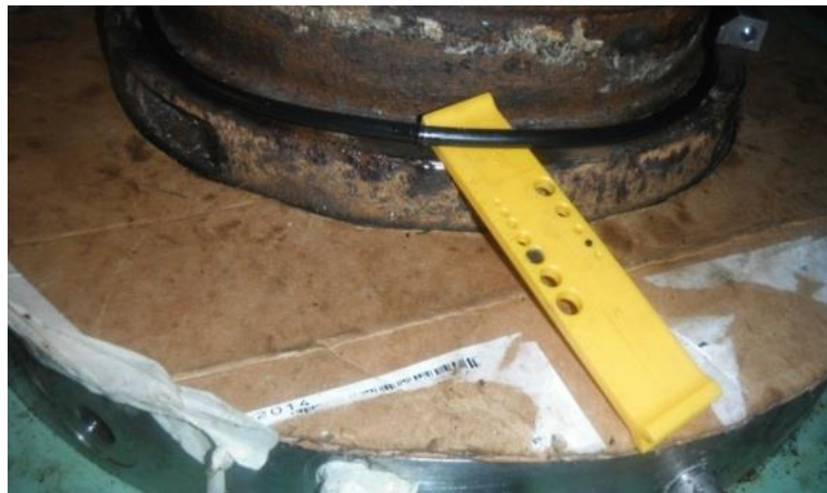
Figura 16. Colocación de Oring
