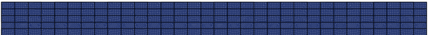
Figura 23. Arreglo de mesas de 5 cadenas en paralelo por 32 en serie. Fuente: Elaboración propia AutoCAD.
