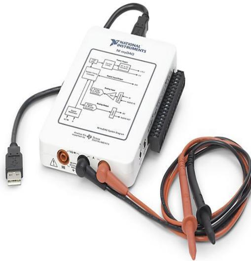
**Figura 13.** Módulo de adquisición de datos *MyDaq* de *National Instruments* [15]
