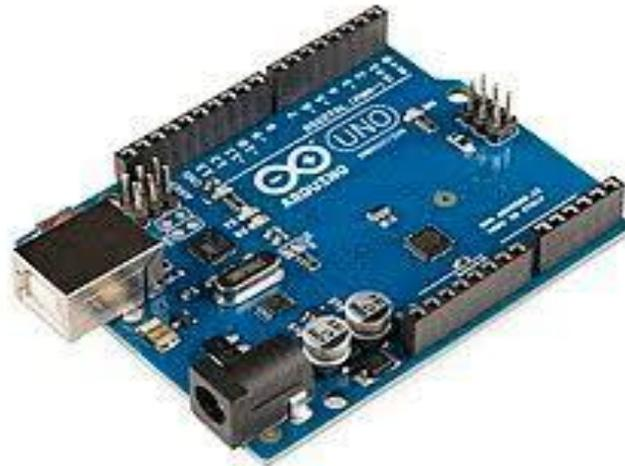
**Figura 12.** Microcontrolador utilizado *Arduino modelo UNO* [14]
