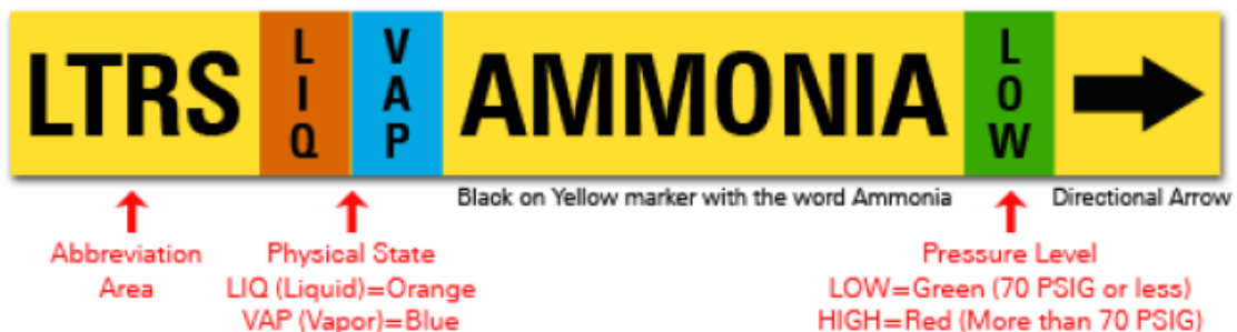
Figura 24. Rotulación de tuberías de amoníaco según la IIAR
