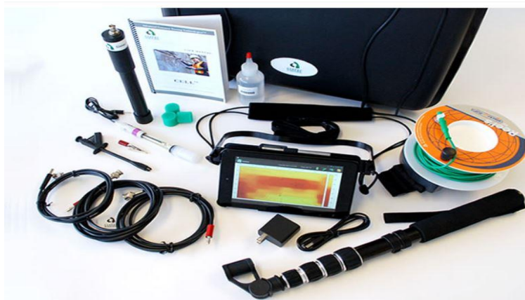
Figura 1: Equipo detección de corrosión Fuente: Giatec Xcell, 2018
