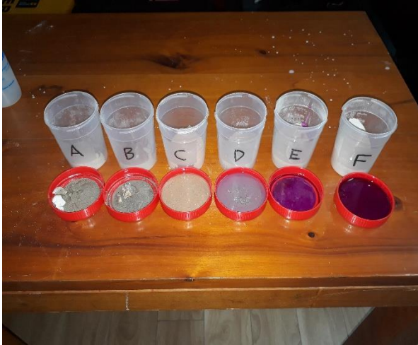
Fotografía 34. Prueba de fenolftaleína
