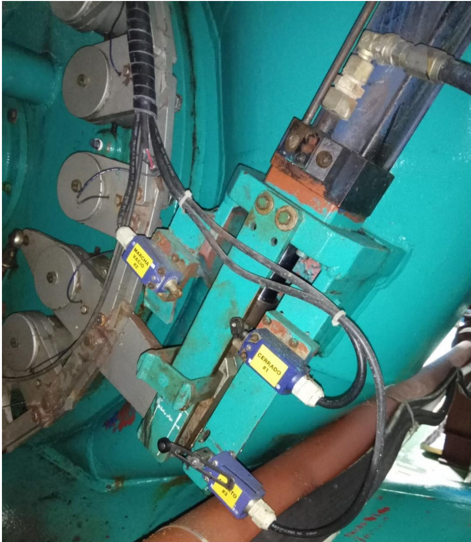
Figura 5.8 Cilindro hidráulico junto con distribuidor.
