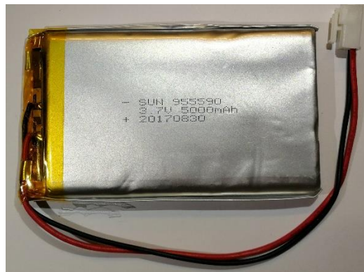
Figura 9. Batería LiPo del Robobo (3.7 V, 5000 mAh)
