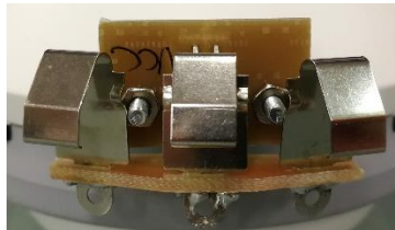
Figura 74. Acople del Robobo con contactos de muelle tipo hoja
