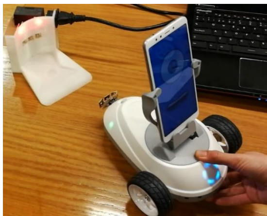
Figura 76. Acople manual del Robobo a la subestación de carga
