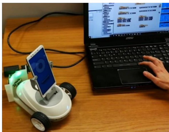
Figura 77. Acople a la base de recarga con el movimiento del Robobo programado en Scratch
