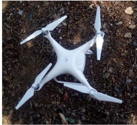
Figura A.1.7 Dron utilizado para hacer el levantamiento topográfico.
