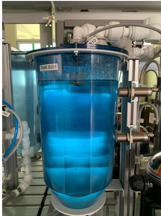
Figura 64. Nivel de agua en el tanque B201 antes de iniciar el programa temporizado 2.
