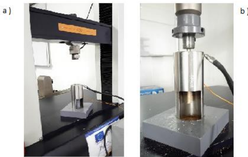
Figura 1. Máquina de ensayo universal (a) y aditamento construido para la fabricación de pellets (b).
