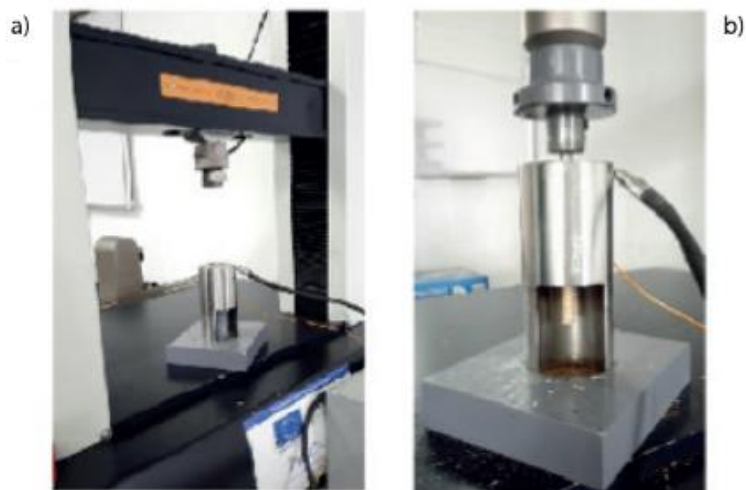
Figure 1. Universal testing machine (a) and attachment built for the production of pellets (b) from torrefied from Gmelina arborea and Dipteryx panamensis . Figura 1. Máquina de ensayo universal (a) y aditamento construido para la fabricación de pellets (b), a partir de aserrín torrefaccionado de Gmelina arborea y Dipteryx panamensis .
