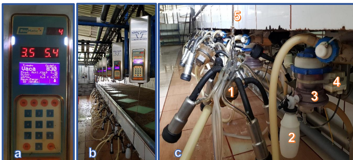
Figura 5. a) Consola y retirado automático - TOUCHPOINT™ para control de ordeño, visualización e ingreso de información individual; b) vista general del equipo automático de ordeño; c) máquina de ordeño (1), frasco recolector (2), flujómetro – SMARTCONTROL™ METER - US (3), medidor de CE - SMARTFLO™ (4) y cable de retirado automático (5). Finca Ganadera La Uno S.A, San Carlos, 2017.
