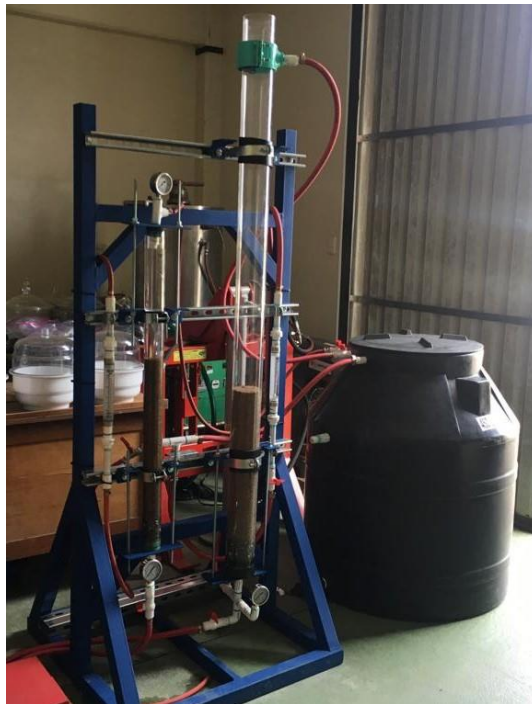
Figura 4-3. Unidad experimental utilizada para ensayos de expansión de medio filtrante.
