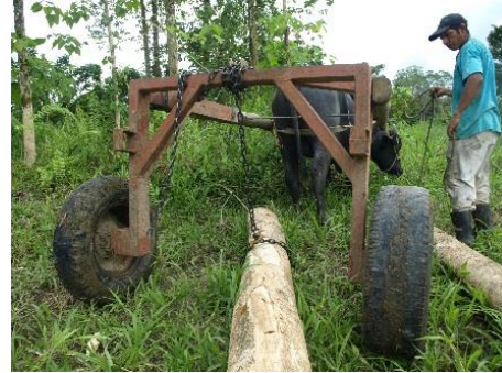
Figura 3. Arrastre de fustes de plantaciones forestales utilizando búfalos de agua con el método del “sulky”. Limón, Costa Rica. 2016.
