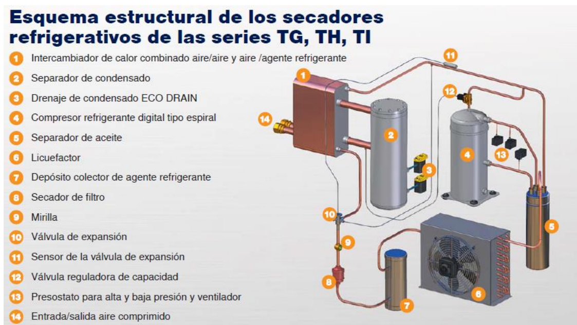
Figura 40. Esquema del circuito interno de refrigeración.
