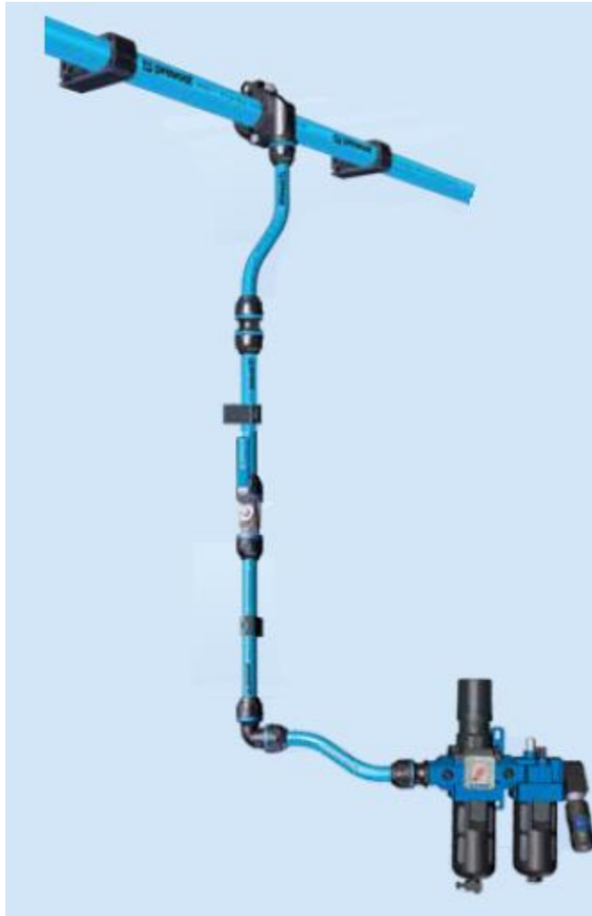
Figura 79. Ejemplo del estándar requerido de bajantes en la planta PIPASA SR.
