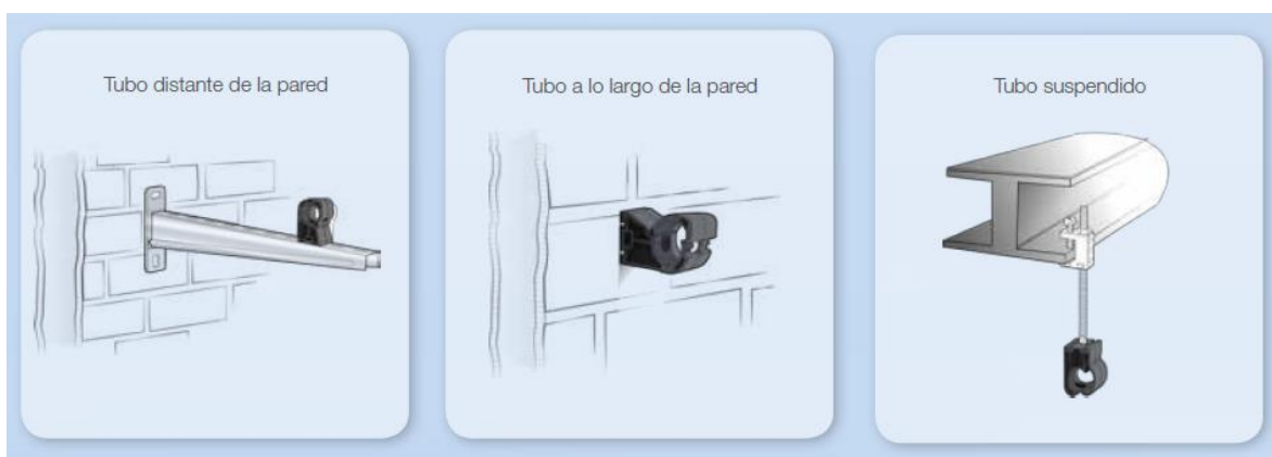
Figura 74. Muestra del tipo de soportes para la tubería PREVOST, Grupo Flotec.
