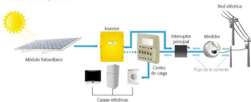
Figura 18. Diagrama básico de un sistema de generación fotovoltaica
