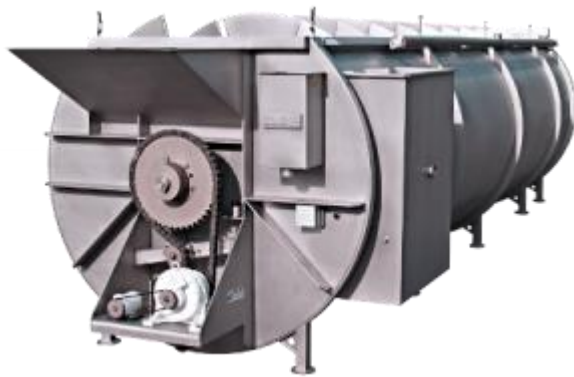
Figura 8. Tanque de agua para enfriamiento de pollo
