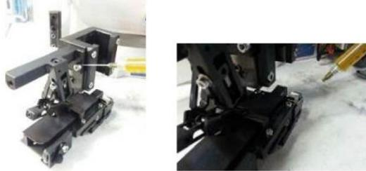
Lubricar alrededor de la pieza que sujeta las cuchillas para volver a colocarla en su sitio como se muestra en la siguiente figura, utilizando la pieza que se presionó inicialmente para desprenderla:
