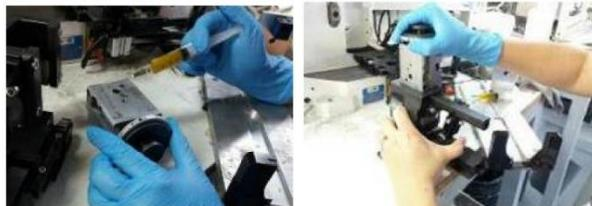
Colocar la cabeza nuevamente a la máquina, realizar 2 pruebas de crimping con su respectivo control de calidad para asegurar que la máquina está funcionando correctamente.
