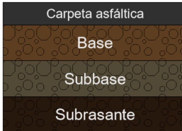
Figura 6. Paquete estructural de un pavimento flexible.
