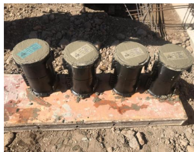
Imagen 11. Cilindro para determinación de resistencia a la compresión en losas y vigas Fuente. Elaboración propia.
