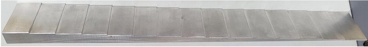
Figura 7.1 - Patrón escalonado de aluminio estandarizado 6061.
