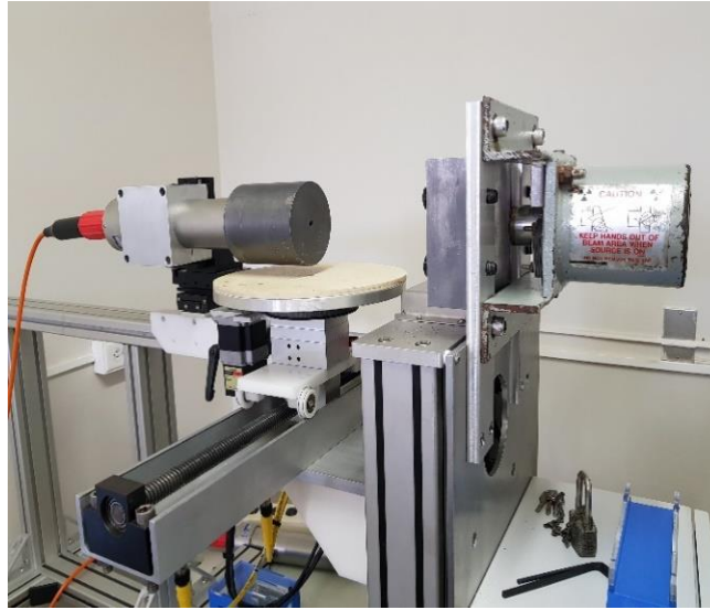
Figura 8.15 - Diámetros orificios de colimadores, detector 8 mm, fuente 1mm, soporte de pieza en acrílico, Etapa 3.
