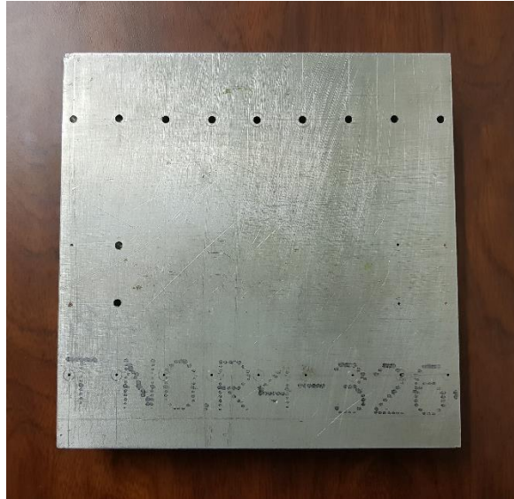
Figura 7.4 – Muestra de aluminio 6061 fabricada mediante proceso de maquinado y con macroporos de profundidad conocida y distribuidos con intervalos regulares en la base.
