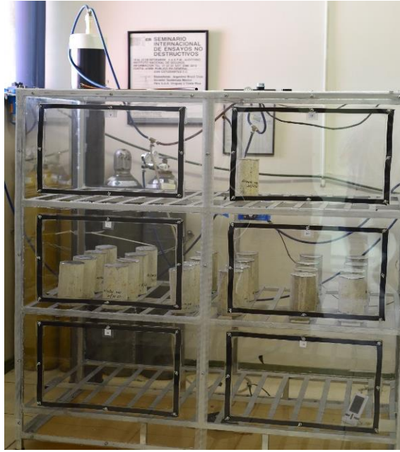
Figura 7.12 – Vista de la cámara de carbonatación acelerada y de las muestras en proceso de carbonatación.
