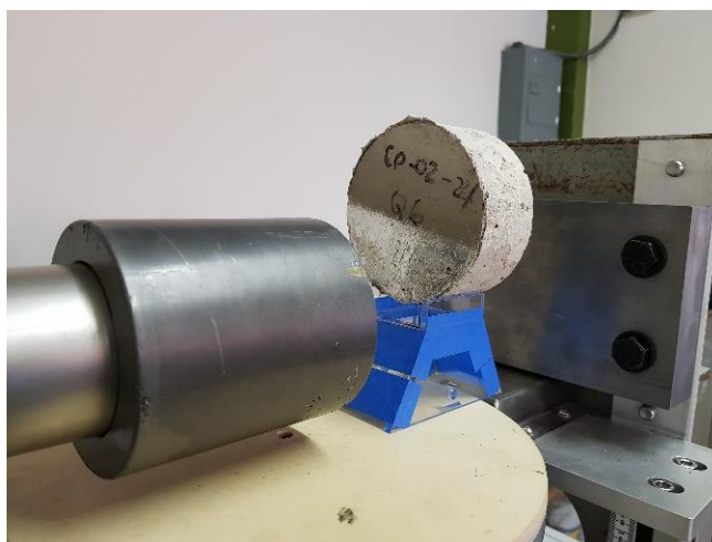
Fig. 8.30- Particular del sistema de medición con gamma scanning, vista del colimador del detector y de la muestra de concreto.
