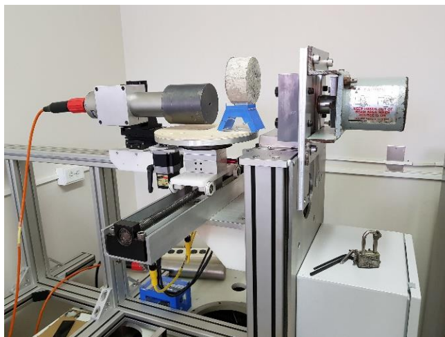
Fig. 8.29- Arreglo del sistema de medición con gamma scanning, vista frontal.
