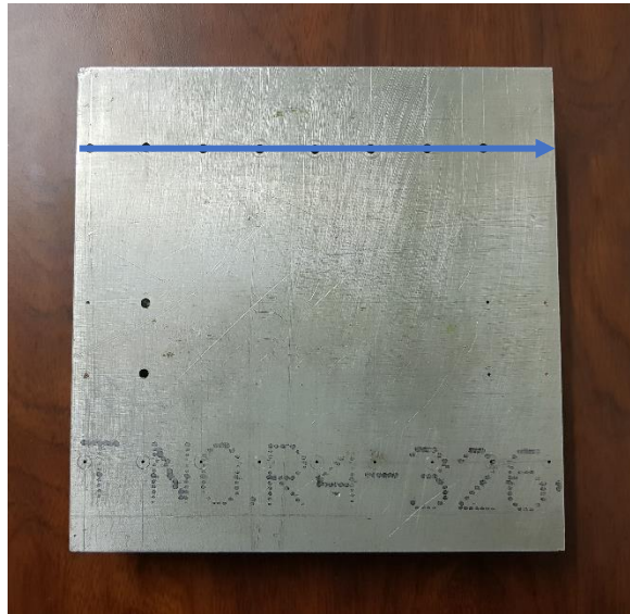
Figura 8.21 – Ubicación del perfil de densidad con gamma scanning en la muestra de aluminio 6061 poroso, manufacturada mediante proceso de maquinado.
