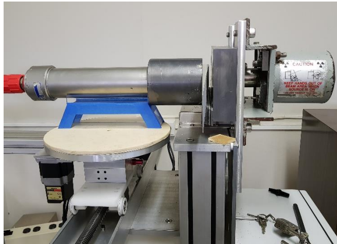
Figura 8.17 - Distribución espacial con distancia mínima entre colimador fuente -pieza-colimador fuente.
