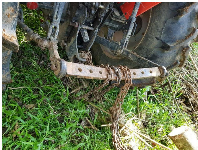
Figura 11. Mecanismo de amarre de las trozas al tractor agrícola.
