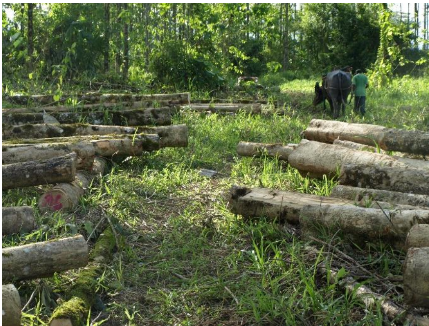
Figura 7. Fustes colocados con el extremo levantado a la orilla de la pista de arrastre del tractor agrícola.
