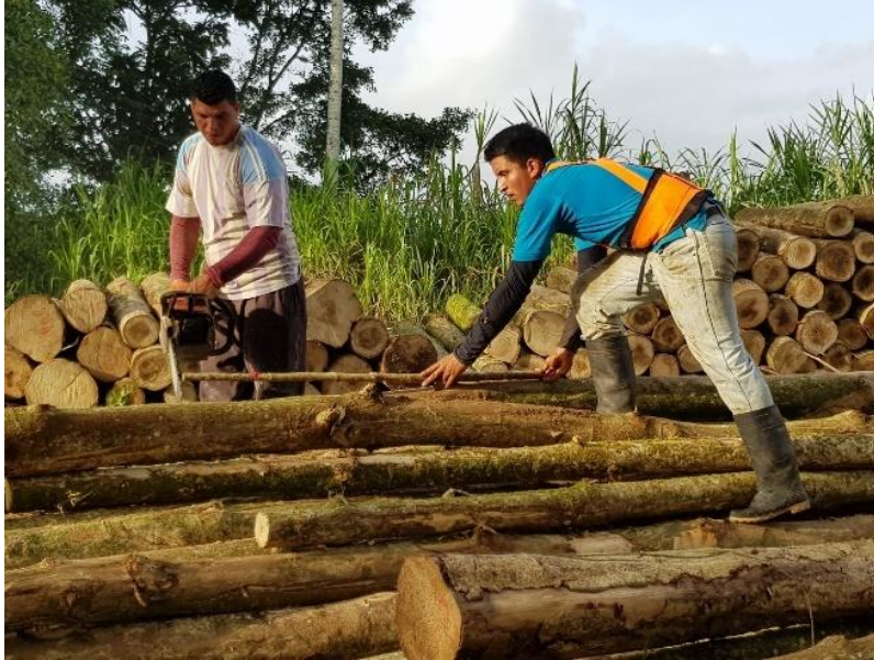
Figura 9. Ejecución del troceo utilizando motosierra y una vara para medir las trozas.
