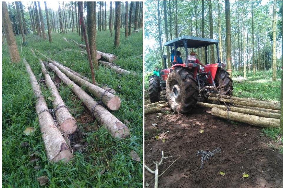
Figura 10. Arrastre de madera con tractor agrícola, utilizando dos juegos de cadenas.
