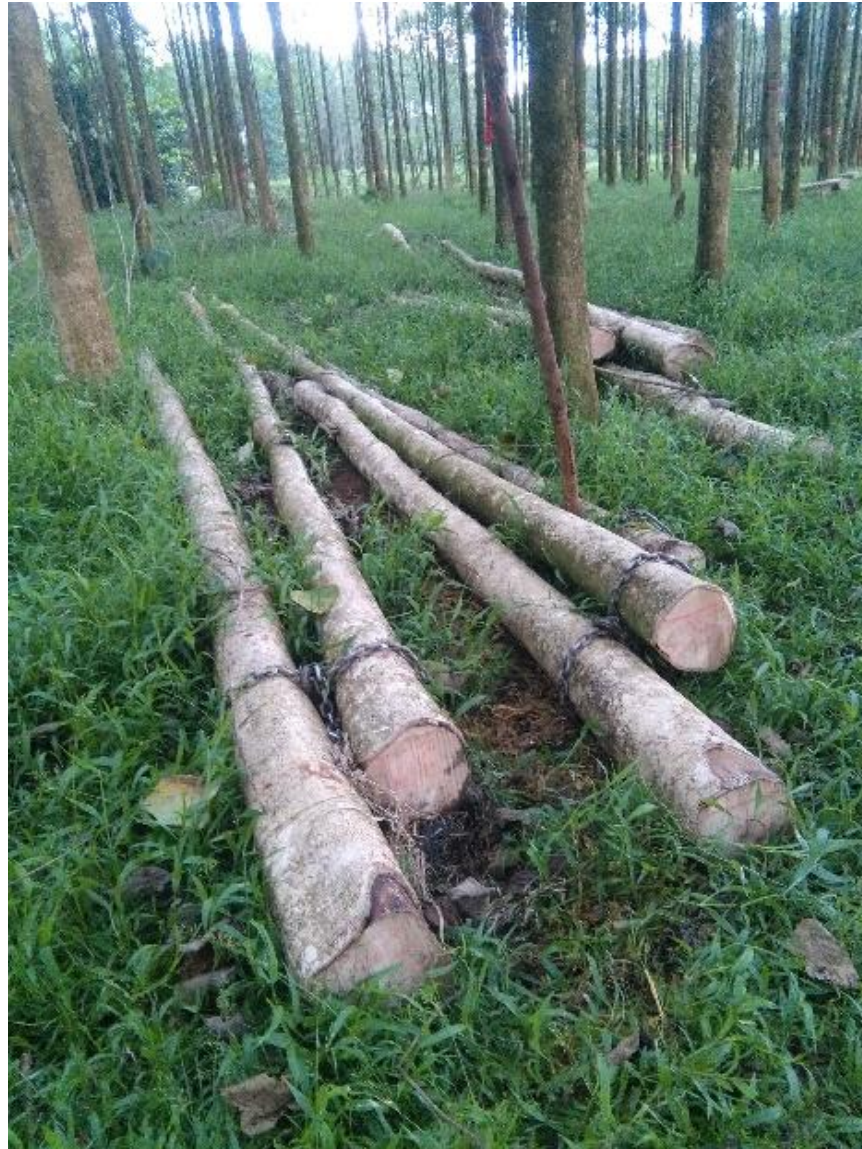
Figura 8. Juego de cadenas utilizado para amarrar una carga mientras el otro juego realiza un viaje al patio de carga.
