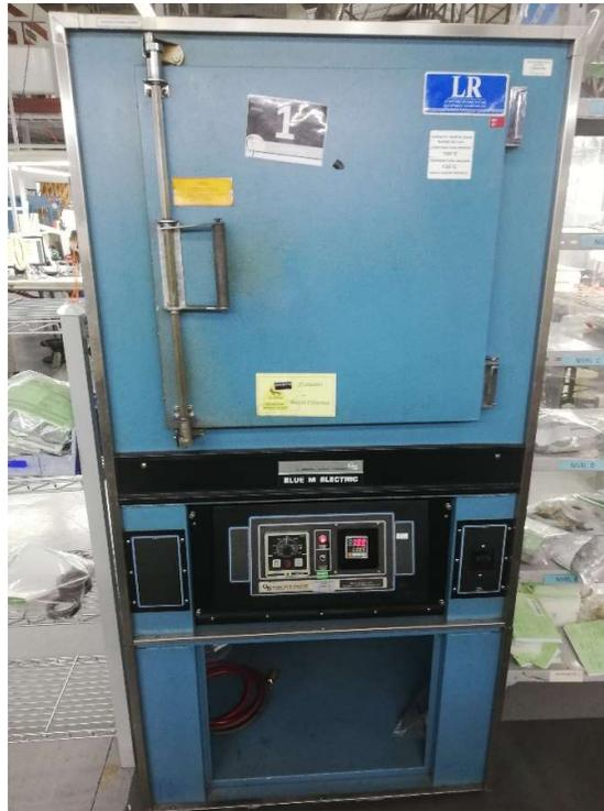
**Figura 3. 2** Horno 220 V de la línea de producción. Fuente elaboración Propia.
