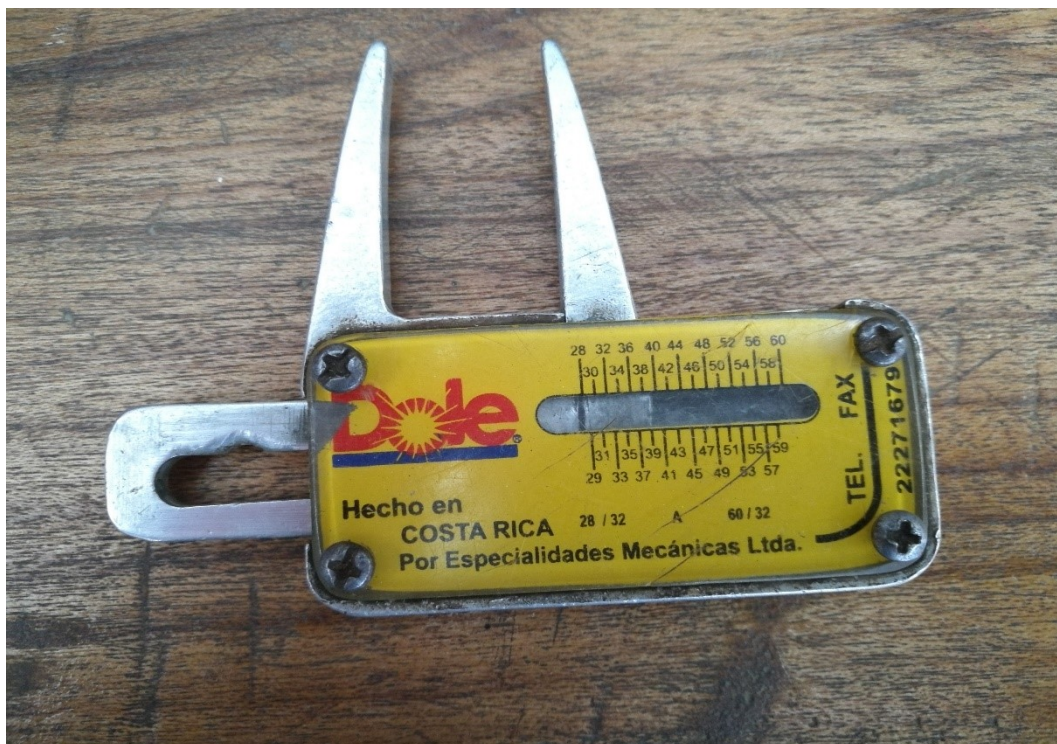
Figura 6. Calibrador utilizado para la medición del grosor del dedo en Musa AAA. Var. Gran Enano, Valle de la Estrella, Limón, Costa Rica, 2017.
