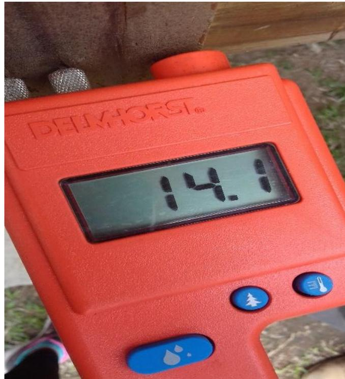
**Figura 10.** Contenido de humedad medido con higrómetro en una vivienda del proyecto Don Sergio, Horquetas de Sarapiquí.
