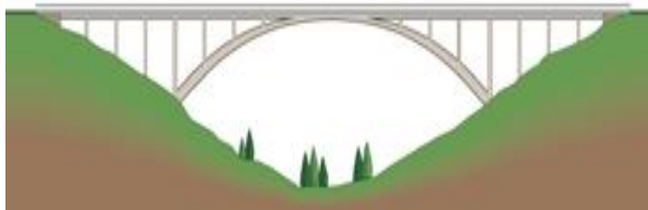
Figura 10. Puente tipo arco de paso superior. Fuente: Ikonet, en línea (s.f.).
