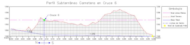
Figura 91b. Perfil longitudinal de la propuesta subterránea en el Cruce 6 (Calle 10), en Paraíso (Anexo 5). Fuente. Elaboración propia, Civil 3D.
