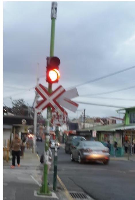
Figura 15. Señalización activa/pasiva colocada en un cruce de la GAM.
