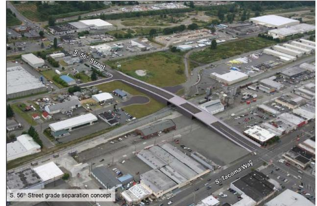
Figura 24. Elevación de la calle en S. 56th Street, sobre las vías del tren. Fuente. WSDOT, 2012
