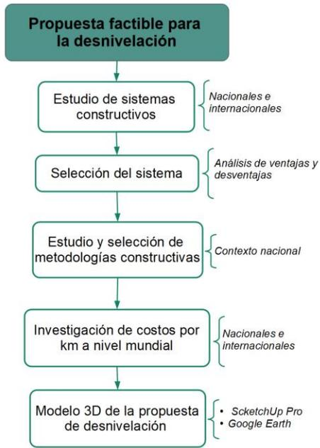
Figura 54. Diagrama de flujo de la metodología utilizada para determinar la propuesta factible para la desnivelación en los cruces 5 y 6 de Paraíso (Anexo 1).
