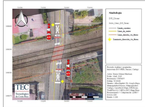
Figura 82a. Propuesta de señalización pasiva-activa para el cruce 6, en Paraiso (Anexo 4).
