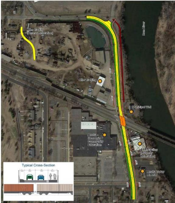
Figura 20. Concepto de alternativa con la carretera sobre el ferrocarril.
