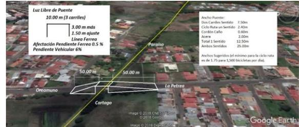
Figura 1. Propuesta de puente vehicular sobre la línea férrea. Fuente. Navarro, et al., 2018.
