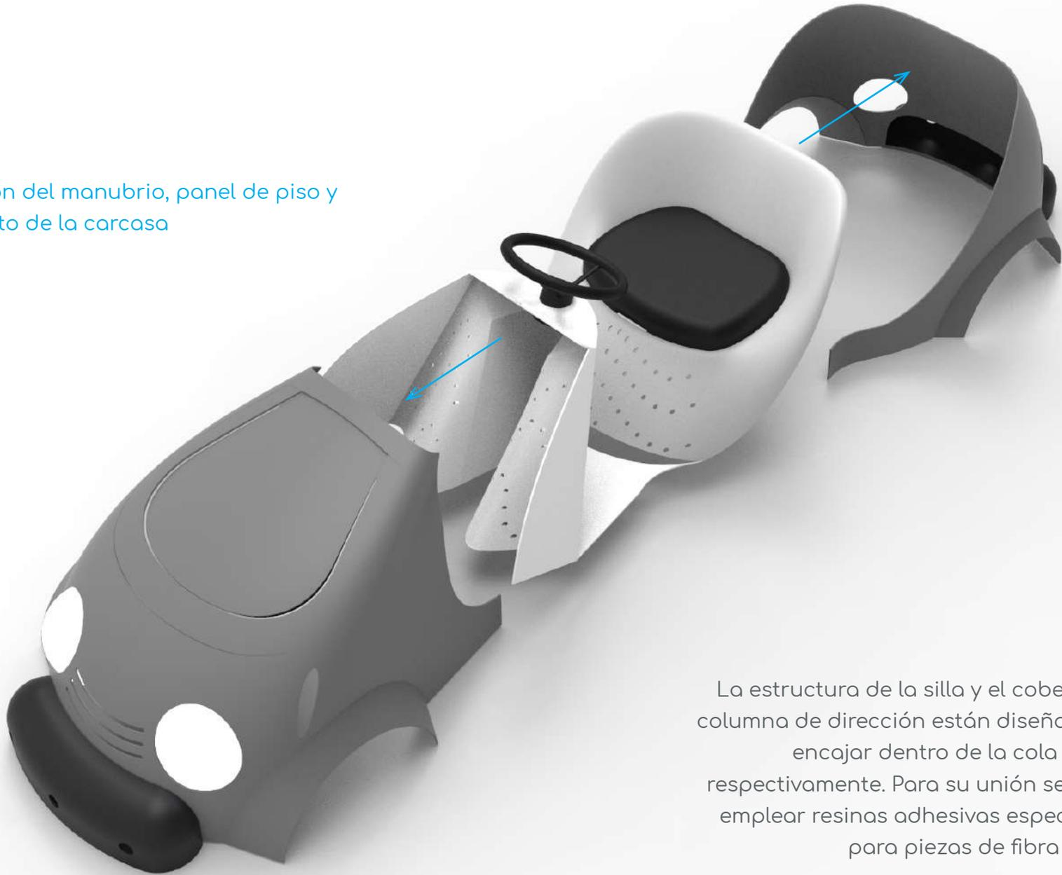
La estructura de la silla y el cobertor de la columna de dirección están diseñados para encajar dentro de la cola y trompa, respectivamente. Para su unión se propone emplear resinas adhesivas especializadas para piezas de fibra de vidrio.
