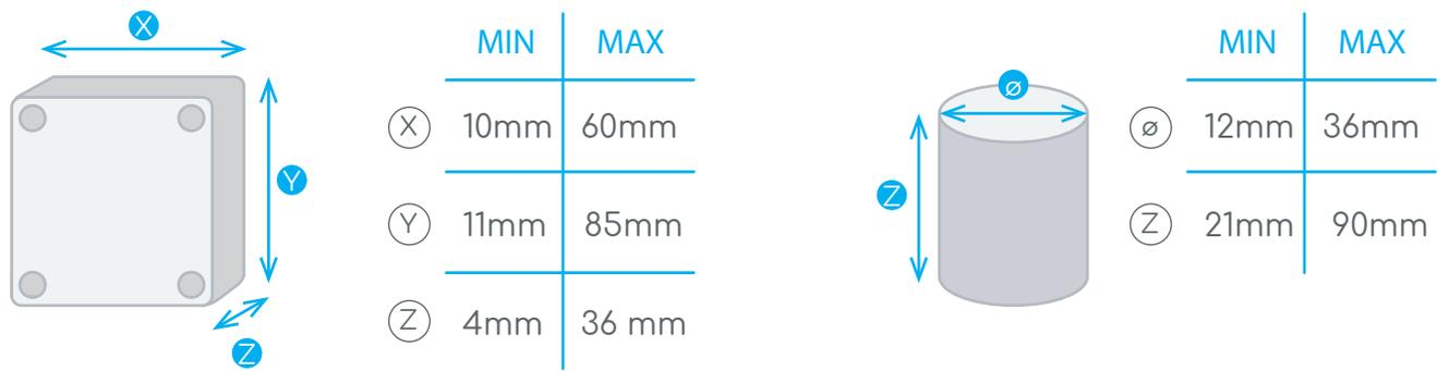
Figura 25. Dimensiones mínimas y máximas de los componentes electrónicos que requieren ser fijados en el interior de la carcasa. Elaboración propia.
