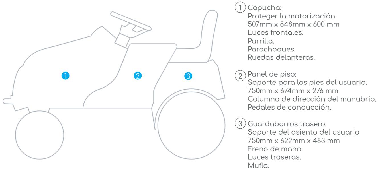
**Figura 14.** Partes originales con sus medidas, funciones y piezas que las componen. Elaboración propia.
