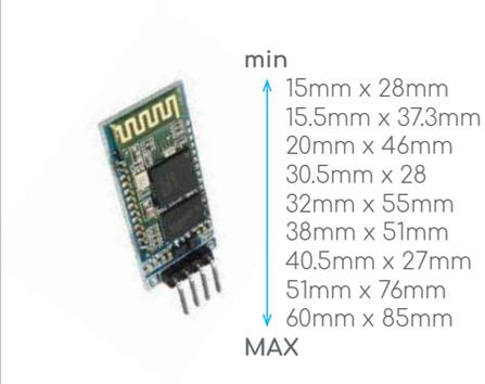
**Imagen 17.** Dimensiones, en milímetros, de un módulo bluetooth. Recuperado el 1 de Septiembre, 2019, de <https://www.electronicaembajadores.com/es/Productos/Detalle/LCBTHT6/modulos-electronicos/modulos-bluetooth/modulo-bluetooth-hc-06>
