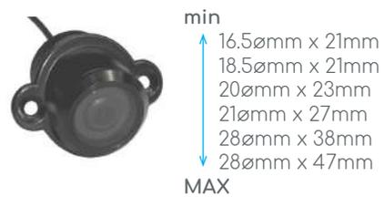
**Imagen 16.** Dimensiones, en milímetros, de una cámara de parachoques. Recuperado el 7 de Septiembre, 2019, de <https://spanish.globalsources.com/gsol/1/Rearview-camera/p/sm/1152125197.htm#1152125197>
