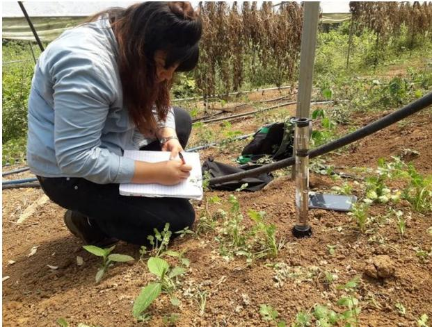
*Figura 4. Prueba de infiltración en el área de estudio.*
