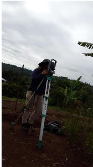
*Figura 2. Levantamiento taquimétrico.*
