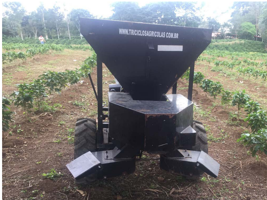
Figura 18. Sistema de salida del abono y tolva.
