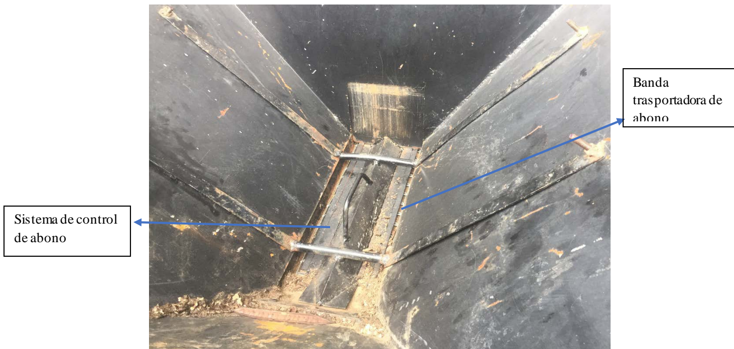
Figura 19. Sistema regulador de la salida del abono.
