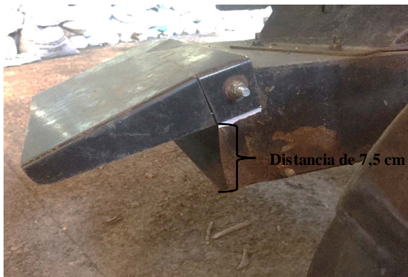
Figura 31. Muestra del ángulo de apertura de la aleta.
