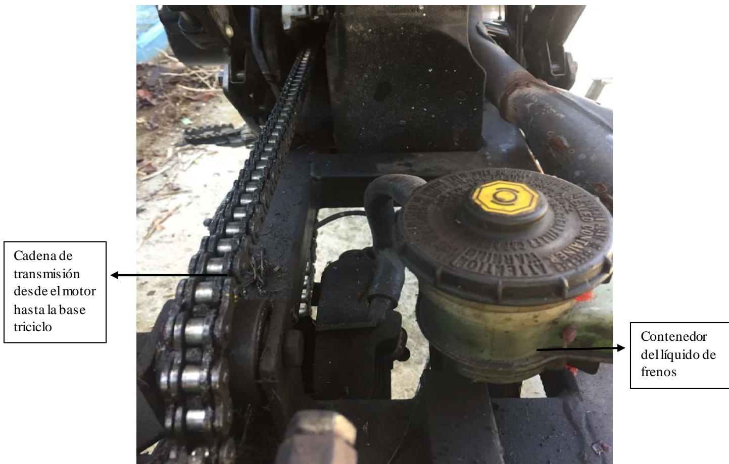
Figura 23. Mecanismo de transmisión de potencia desde el motor.
