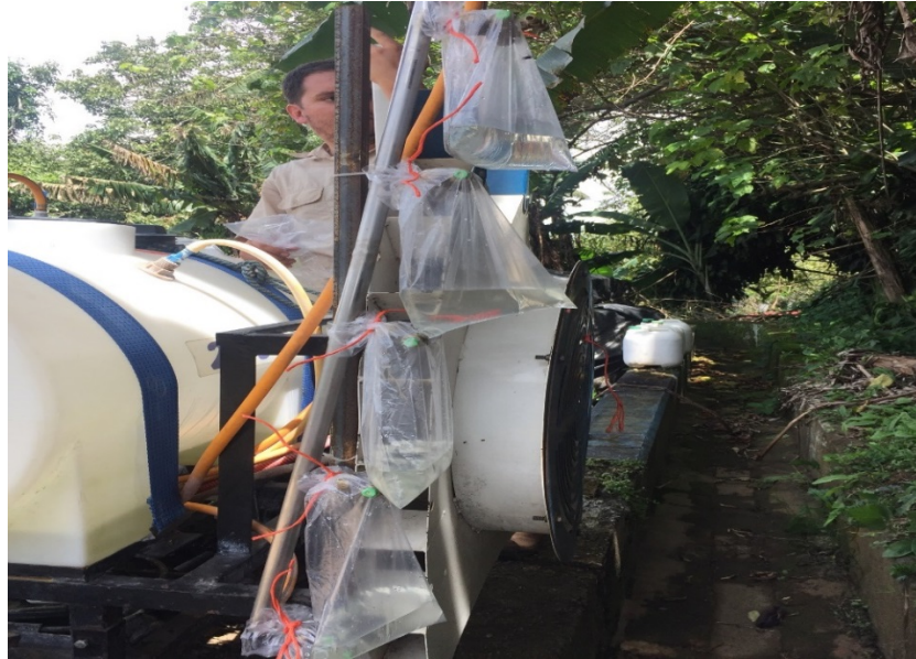
Figura 5. Colocación de bolsas para la calibración de la pulverizadora.
