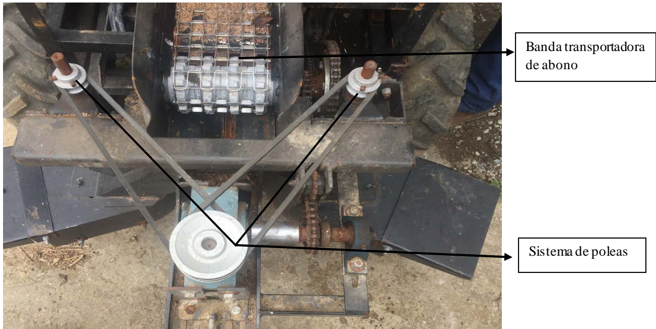
Figura 15. Sistema de poleas y fajas de la abonadora.
