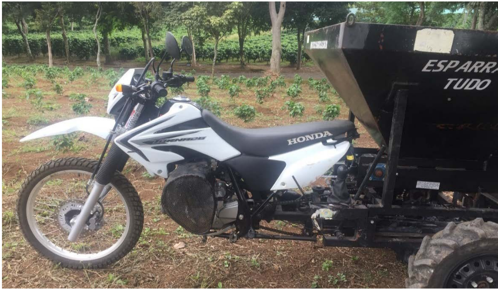
Figura 20. Motocicleta con abonadora acoplada.
