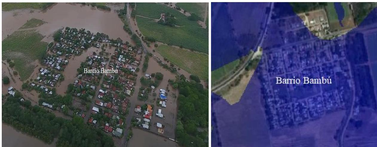
*Figura 37. Barrio Bambú durante la tormenta Nate y manchas de inundación generadas con el modelo hidrodinámico.*
