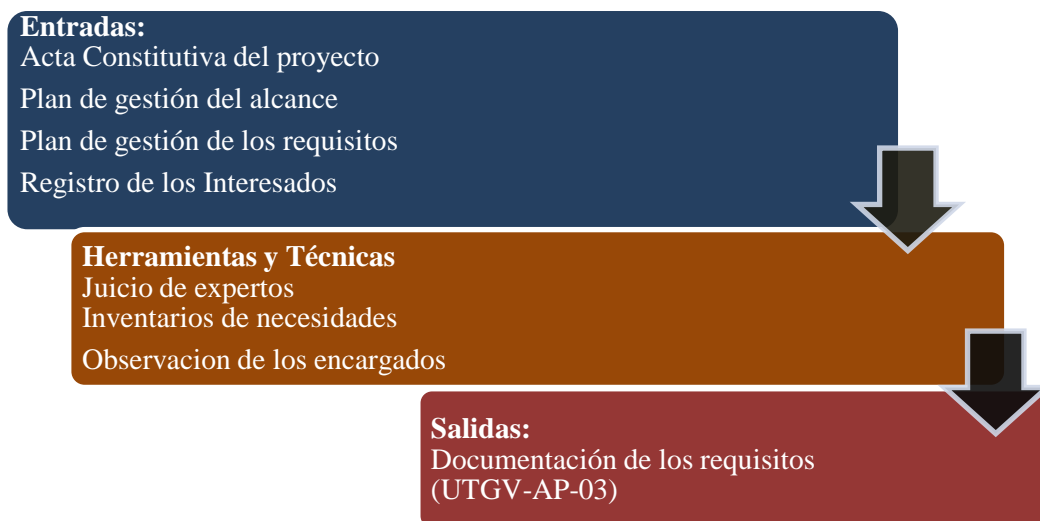
Figura 6-5. Proceso para la recopilación de requisitos Fuente: Elaboración propia, a partir del PMBOK 6ta edición, 2019
