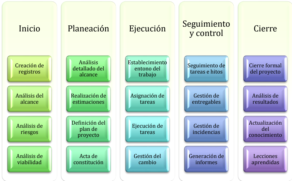
Figura 5.2. Esquema de las fases del ciclo de vida de un proyecto. Fuente: Elaboración propia a partir del PMBOK®.
