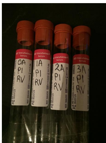
Figura 7. Tubos de ensayo utilizados para almacenar aire durante la determinación de GEI en piña. Finca El Tremedal, San Carlos, Costa Rica. 2016.
