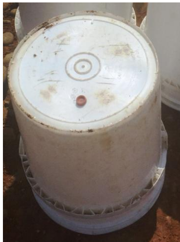
Figura 5. Cámara estática para muestreo de aire durante determinación de GEI en piña. Finca El Tremedal, San Carlos. 2016.
