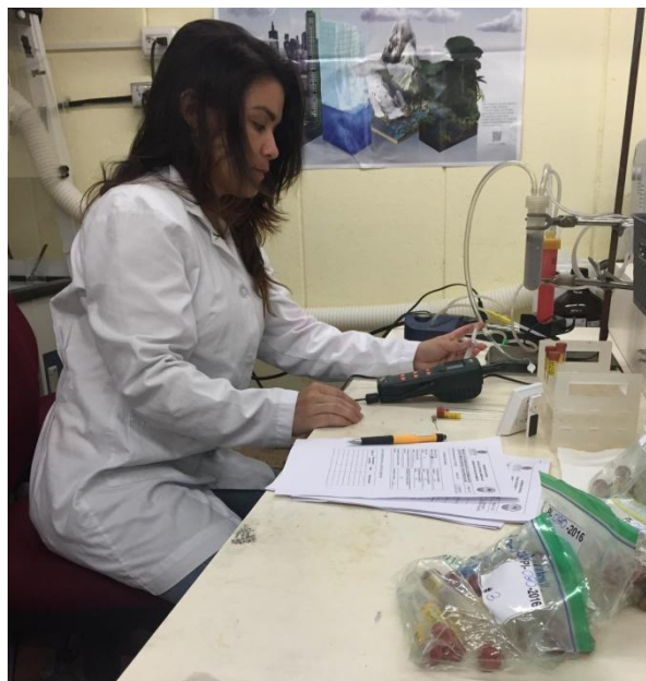
Figura 10. Momento de inyección de aire en detector de CO 2 . Laboratorio de Análisis Ambiental, Universidad Nacional (UNA). Heredia, Costa Rica. 2017.
