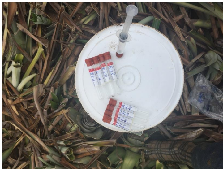
Figura 6. Momento de extracción de aire durante la determinación de GEI en piña. Finca El Tremedal, San Carlos, Costa Rica. 2016.
