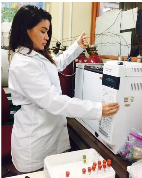
Figura 9. Momento de inyección de aire en cromatógrafo para determinación de \text{CH}_4 durante investigación sobre GEI en piña. Laboratorio de Análisis Ambiental, Universidad Nacional (UNA). Heredia, Costa Rica. 2017.
