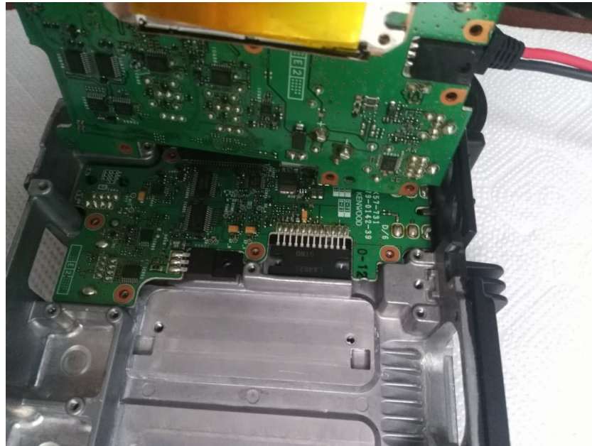
Figura D.2: Disipador original y placa secundario Fuente: Elaboración Propia
