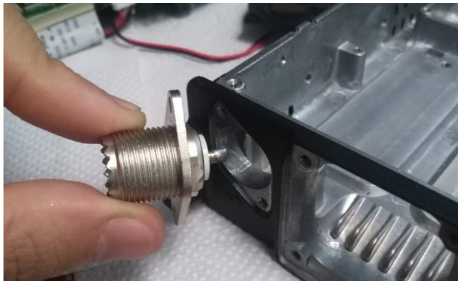
Figura D.3: Disposición del conector de la antena Fuente: Elaboración Propia
