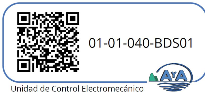
Figura 35. Ejemplo de calcomanía propuesta para Bomba Dosificadora 01-01-040-BDS01
