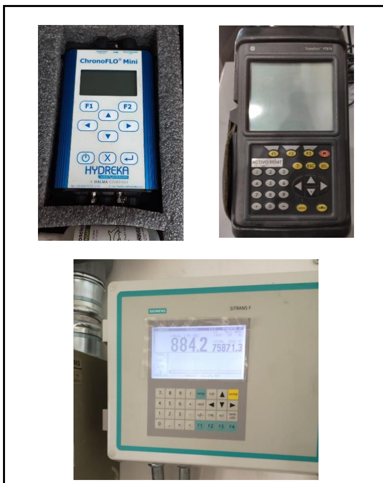
Figura 26. Instrumentos de Medición de Caudal.
