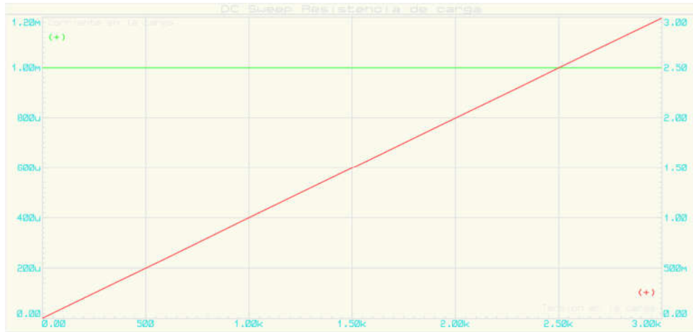
Figura 6.17. Comportamiento de la tensión y corriente de carga ante el cambio de la resistencia de carga.
