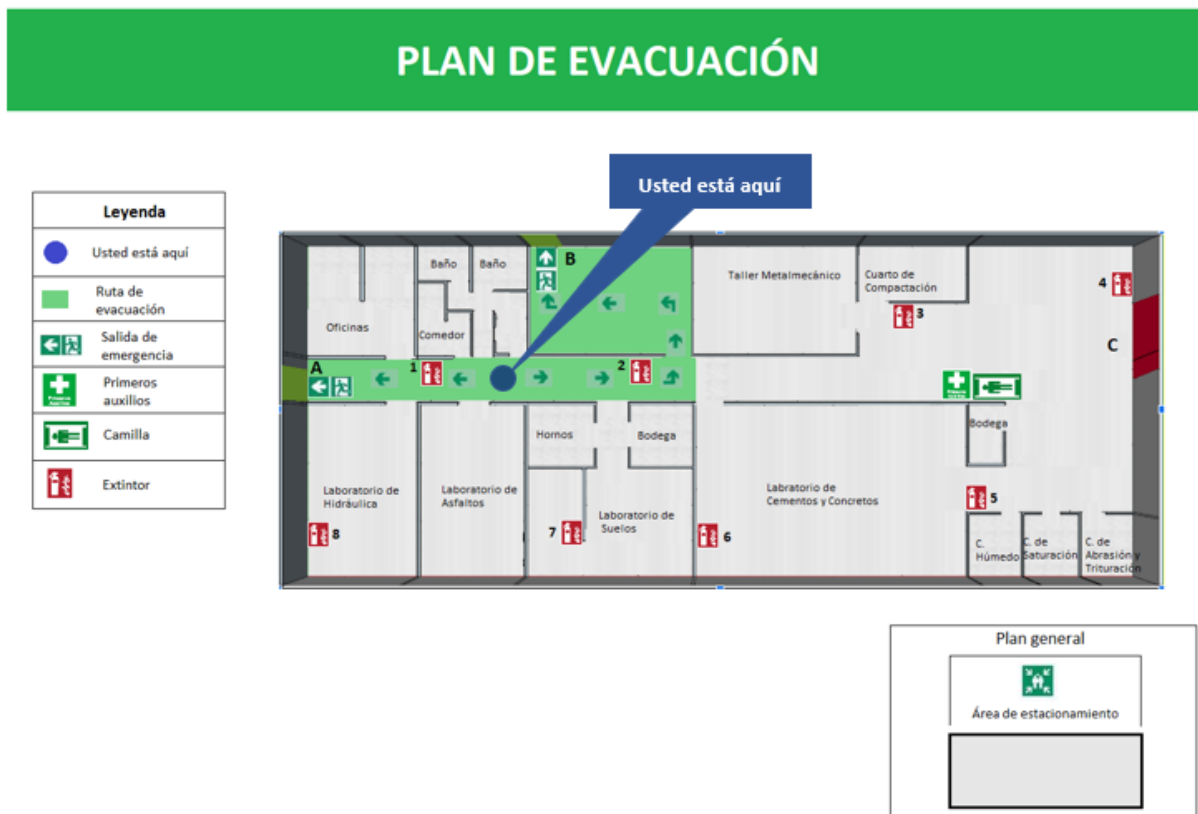
Figura VII-6. Reubicación de la ruta de evacuación.
