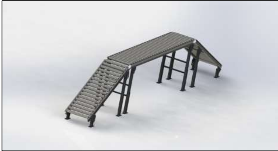
Figura 11. Renderizado del sistema de transporte de rodillos sueltos y por gravedad. Fuente: Elaboración propia. Solidworks 2019
