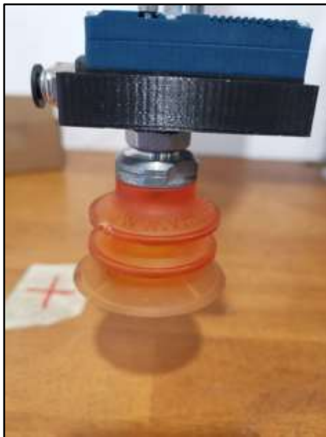
Figura 34. Acople de la válvula generadora de vacío con la boquilla y el robot SCARA. Fuente: Elaboración propia.
