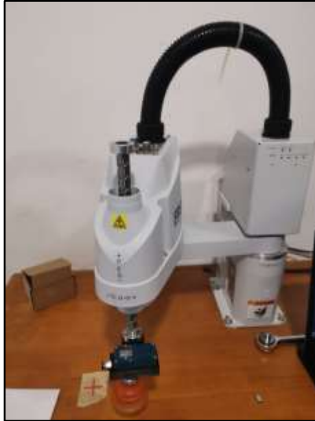
Figura 32. Robot SCARA marca Epson utilizado para realizar las pruebas del sistema de ingreso de sobres. Fuente: Elaboración propia.
