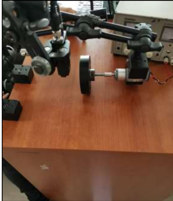
Figura 36. Ensamble de la rueda con el motor para realizar la prueba de expulsión de sobres. Fuente: Elaboración propia.
