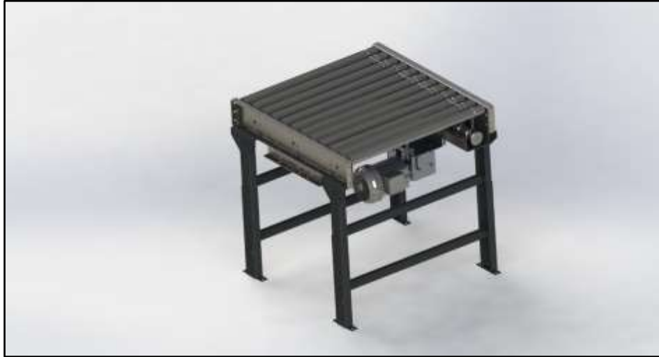
Figura 12. Renderizado del sistema de transporte de rodillos motorizado. Fuente: Elaboración propia. Solidworks 2019
