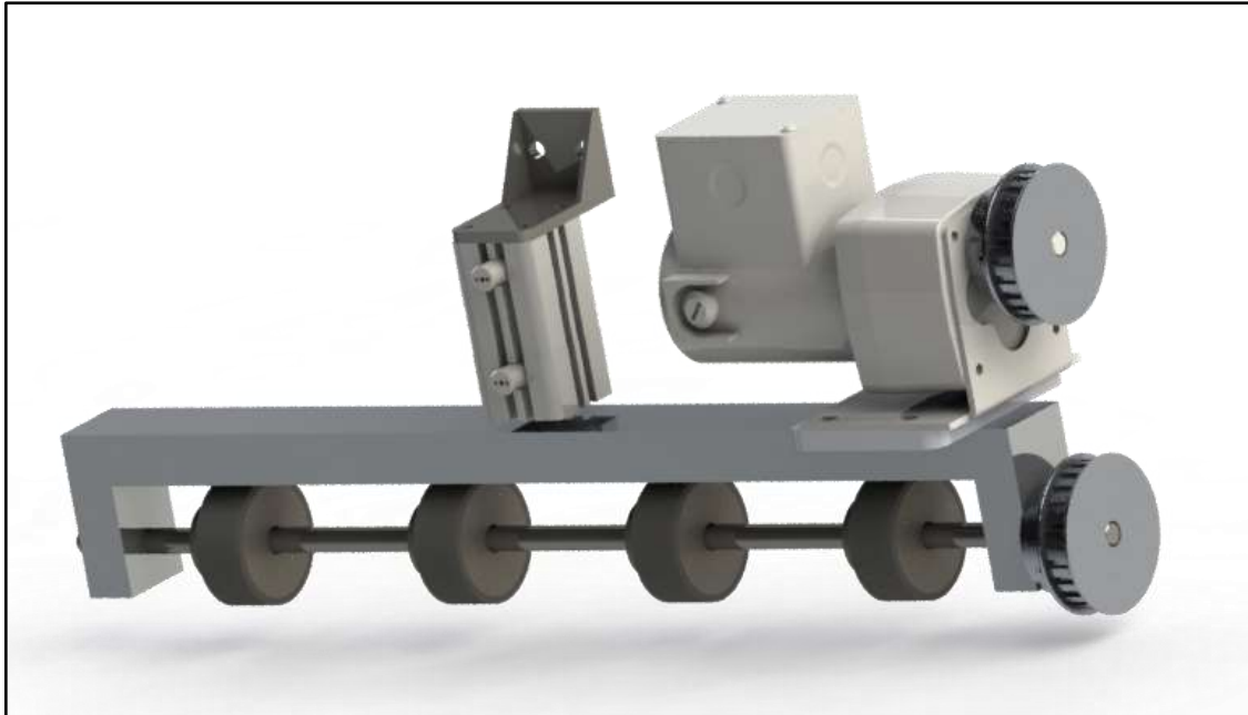
Figura 25. Renderizado del sistema de expulsión de ruedas. Fuente: Elaboración propia. Solidworks 2019
