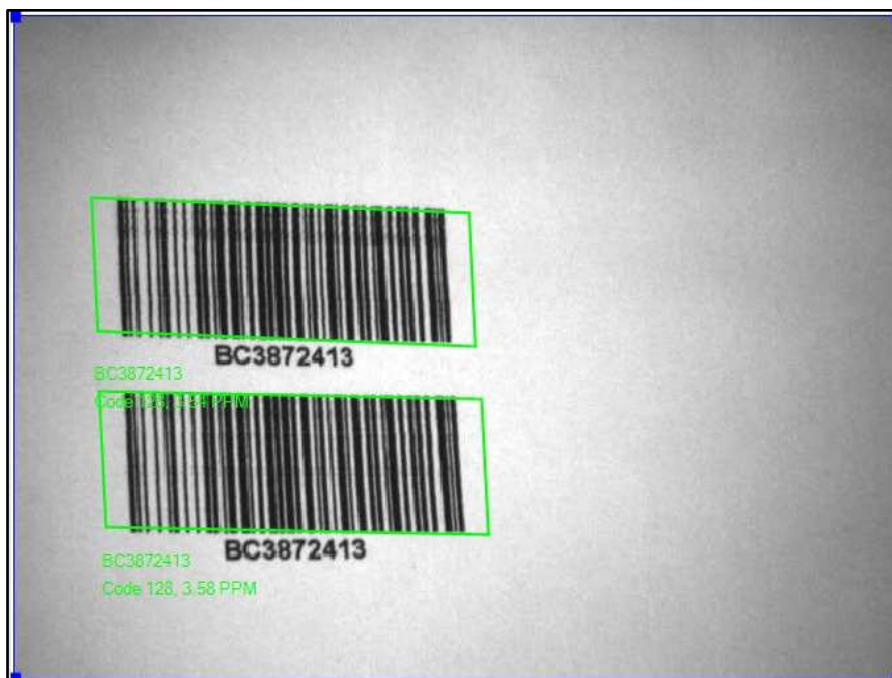
Figura 49. Lectura del software de dos códigos de barras. Fuente: DataMan Setup Tool
