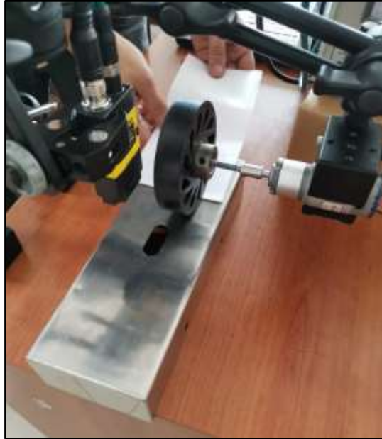
Figura 37. Adhesión de una pieza de acero inoxidable a la prueba para una simulación más real. Fuente: Elaboración propia.
