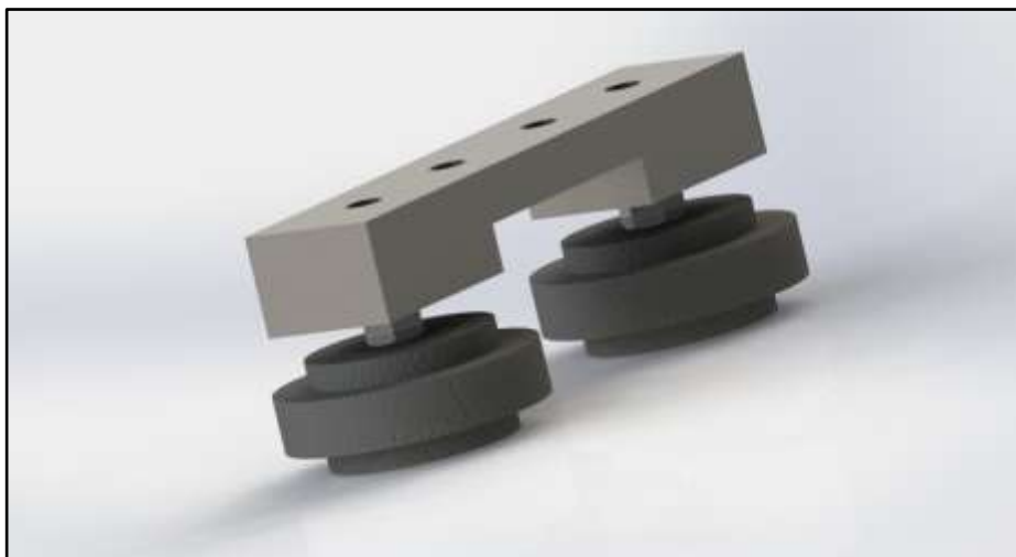
Figura 19. Renderizado del fixture de las ruedas para acople entre el fixture del Pick & Place y el perfil de aluminio en soporte. Fuente: Elaboración Propia. Solidworks.
