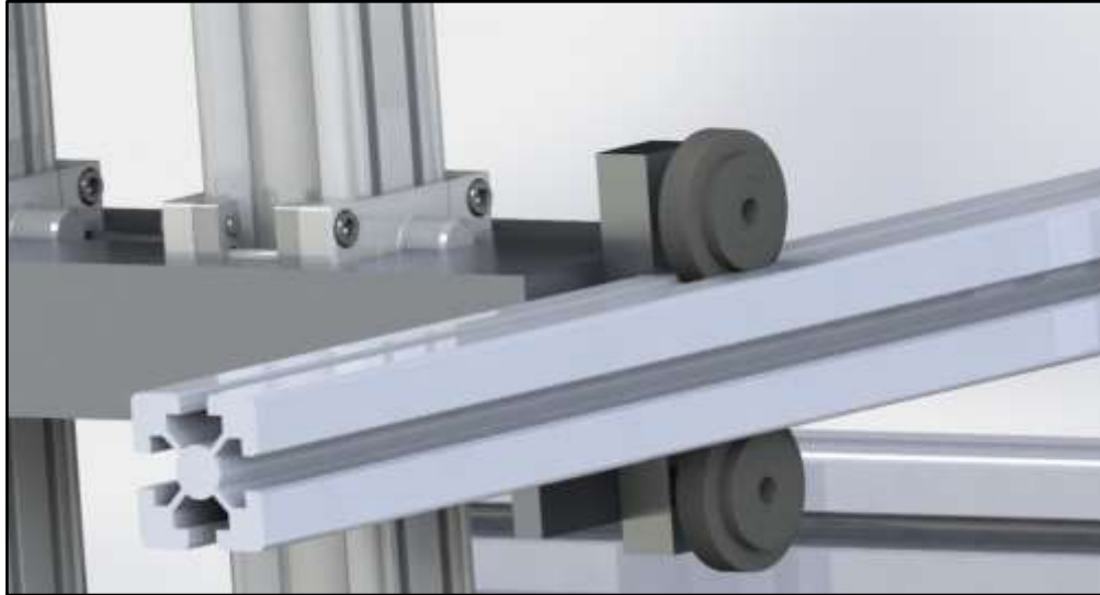
Figura 18. Renderizado del acople de las llantas y el fixture del sistema Pick & Place con el perfil de soporte. Fuente: Elaboración propia. Solidworks 2019
