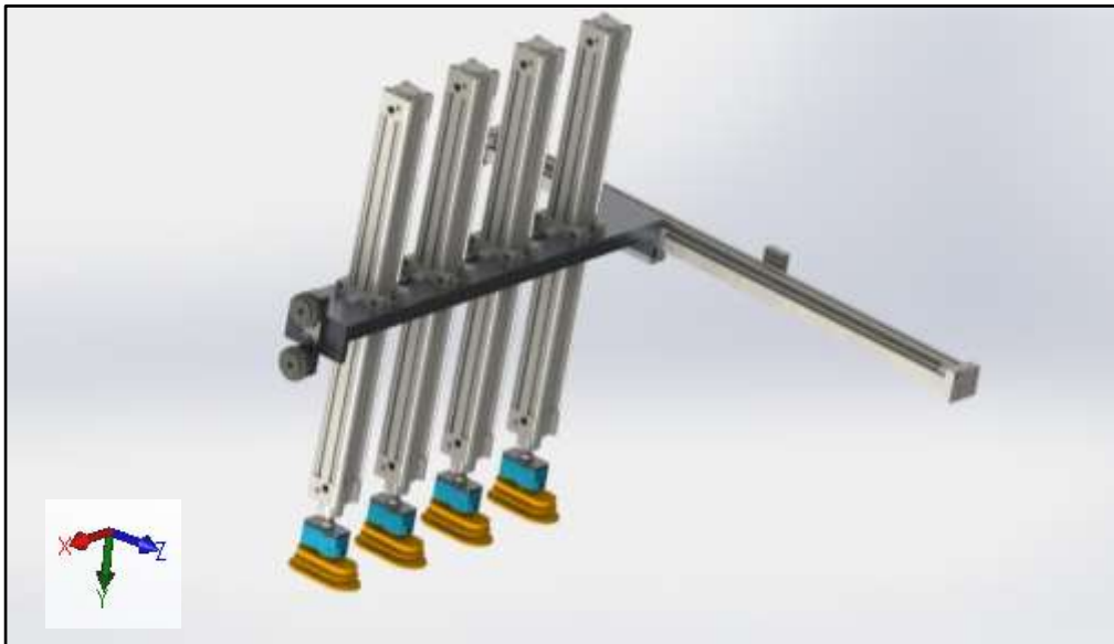
Figura 13. Renderizado de sistema Pick & Place utilizado para transportar los sobres desde las cajas hasta el iTrak. Fuente: Elaboración propia. Solidworks 2019
