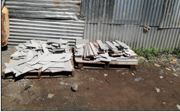
Figura 74. Residuos cerámicos para reutilizar como relleno. Fuente: Elaboración propia en visita a proyecto en Siquirres.
