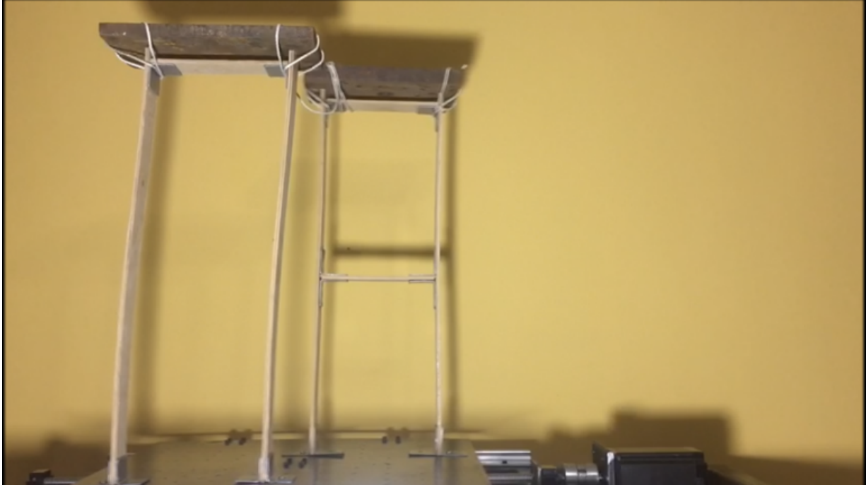
Figura 48. Movimiento inducido en modelo de dos pisos, con sobrecarga. Fuente: Autoría propia.
