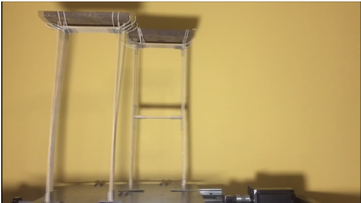
Figura 47. Movimiento inducido en modelo esbelto, con sobrecarga. Fuente: Autoría propia.
