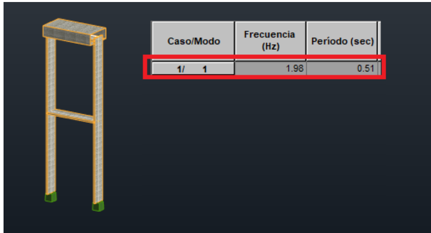
Figura 44. Período del marco de edificio de dos pisos, con sobrecarga Fuente: Autoría propia, Robot Structural 2020.
