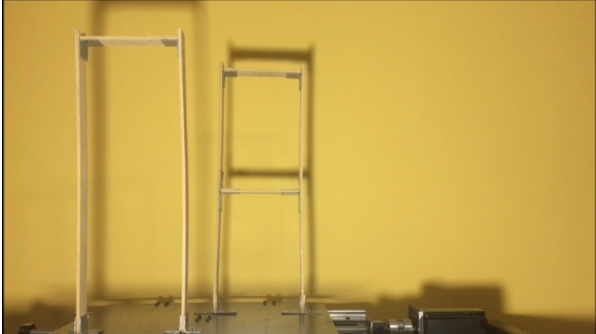
Figura 46. Movimiento inducido en modelo de dos pisos, sin sobrecarga. Fuente: Autoría propia.
