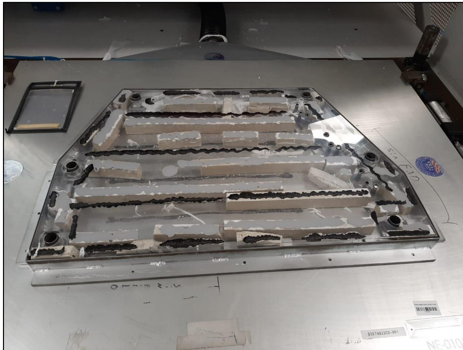
Anexo 1. Troquel de corte existente en la empresa.
