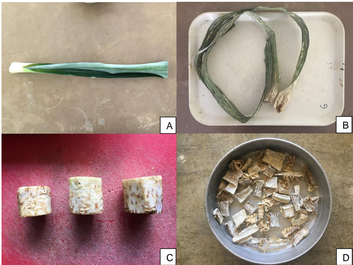
Figura 22. Proceso de secado de la submuestra hoja y submuestra tallo para cada repetición, Laboratorio de Análisis Agronómicos, TEC San Carlos, 2020. Nota: A) Hoja D en fresco. B) Hoja D seca a 55°C durante 5 días. C) Tallos en fresco. D) Tallos secos a 55°C durante 5 días.
